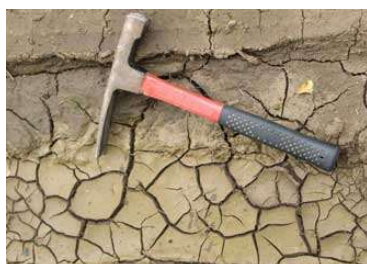
Figure 3-12 : Sol argileux à gauche et fissuration due au retrait-gonflement d'argiles à droite (BRGM)
