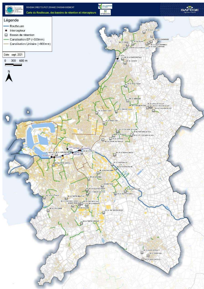
Figure 4-5 : Localisation des bassins de rétention des eaux pluviales, avec le réseau structurant
