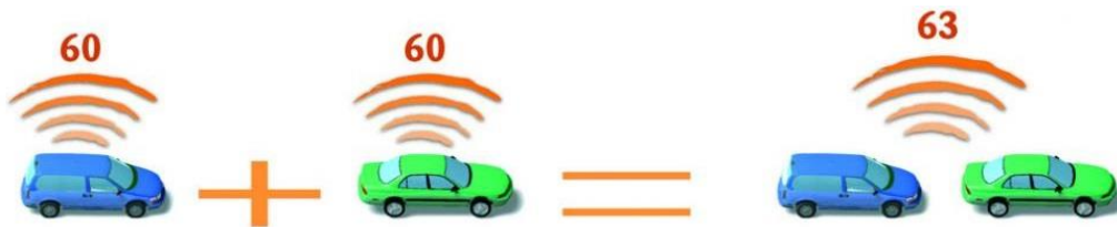
Figure 3 - Addition de deux sources de bruit de même intensité
