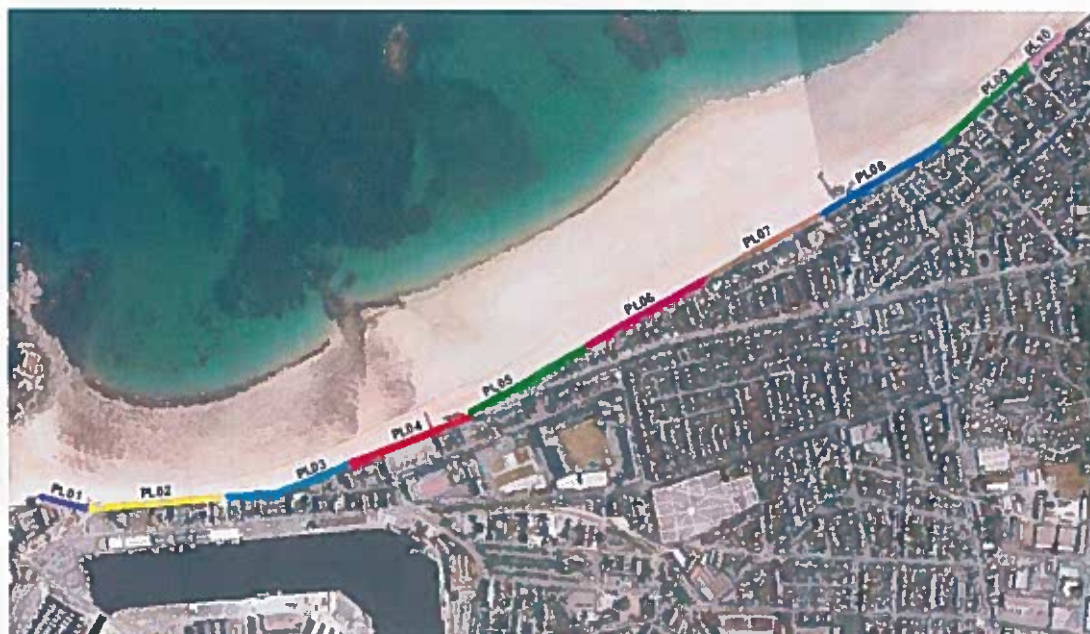
Figure 7-5 : Division de la digue de Saint Malo en tronçons d'altitude homogène
