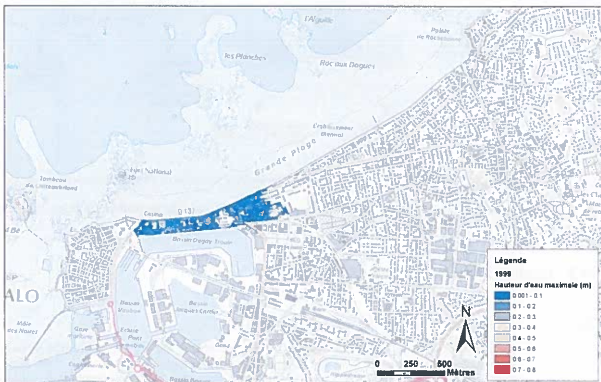
Figure 7-8 : Résultat du calage du modèle de franchissement pour la tempête de décembre 1999
