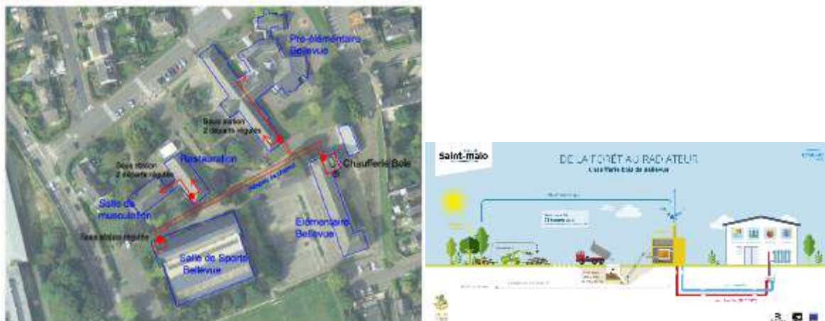
FIGURE 100 : RESEAU DE CHALEUR CHAUFFERIE BOIS BELLEVUE
