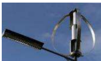
FIGURE 86 : EXEMPLES D'APPLICATION DE MICRO-EOLIEN SUR LUMINAIRE
