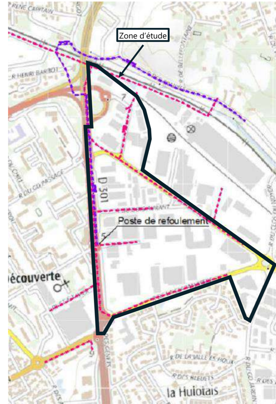
FIGURE 32 : RESEAU D'ASSAINISSEMENT SUR LA ZONE D'ETUDE
