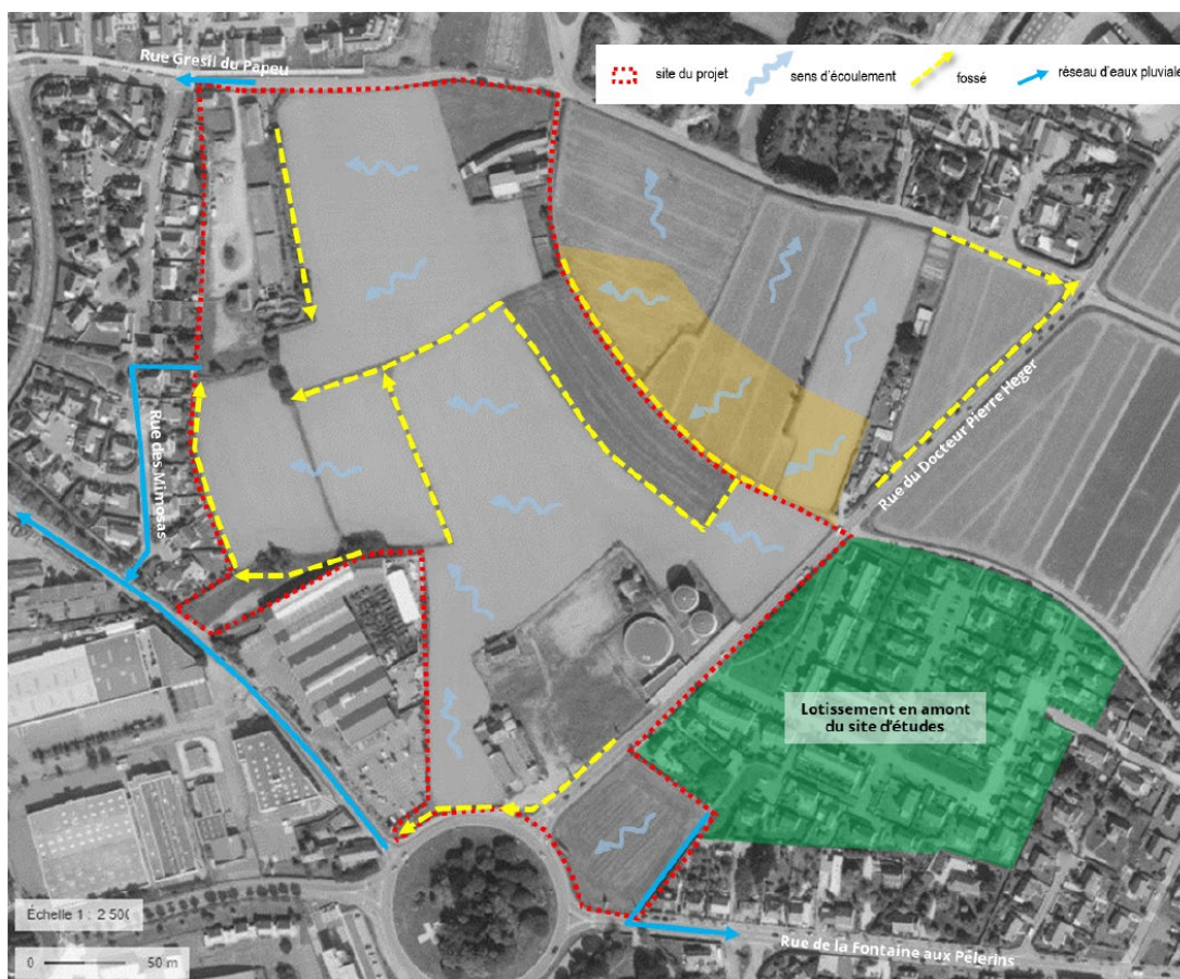
Fonctionnement hydraulique du secteur de la Houssaye, 2025
