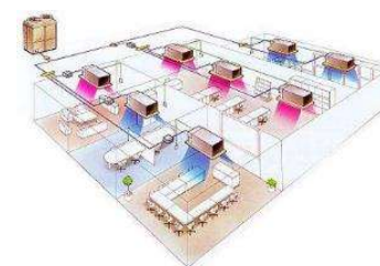
Principe de la climatisation à détente directe
