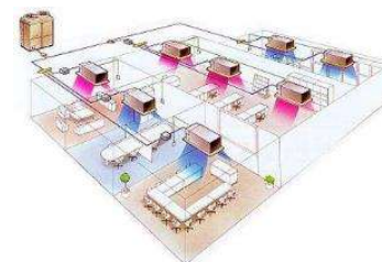
Principe de la climatisation à détente directe
