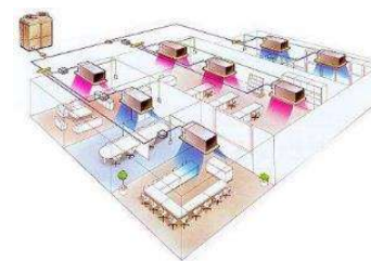
Principe de la climatisation à détente directe
