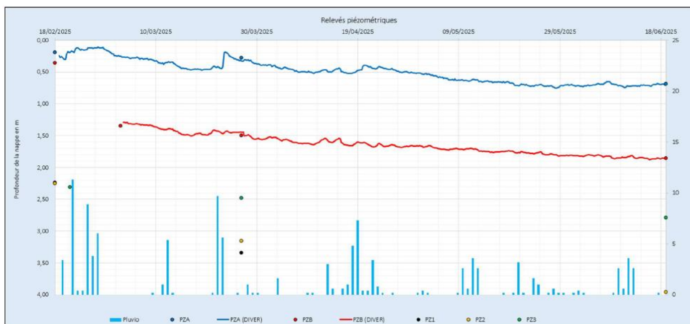
Figure 4 : Résultats du suivi piézométrique (profondeur de la nappe par rapport au TN au droit du PzA, en bleu, et du PzB, en rouge) et mise en perspective avec la pluviométrie à la station de Dinard, entre le 18/02/2025 et le 18/06/2025 (source : Soler IDE)
