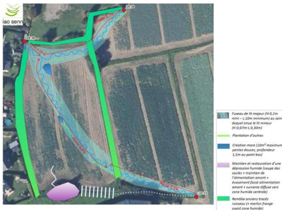
Figure 248 : Schéma de principe de l'aménagement de la zone humide et du reméandrage du cours d'eau, lao senn, 2025
