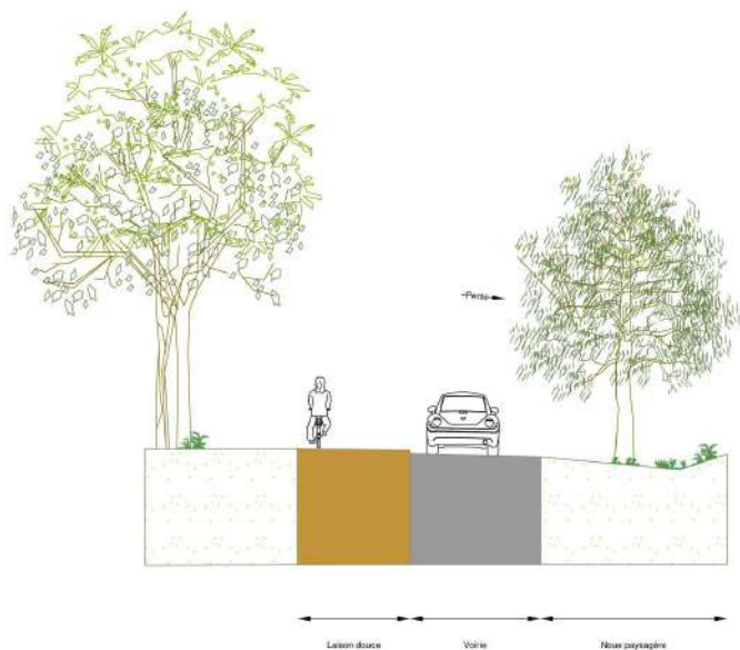
Figure 226 : Schéma de principe – Rétention / Infiltration à la parcelle une noue - (source : iao senn), 2025
