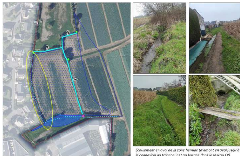
Figure 60 : Illustration des écoulements en aval de la zone humide, iao senn, 2025
