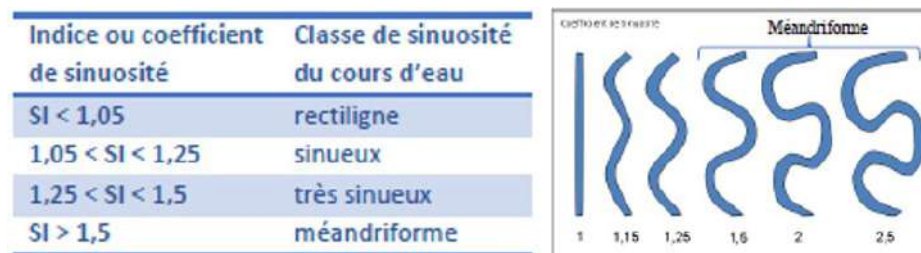
Figure 219 : Indice et classe de sinuosité (source : FDPPMA35, adapté de Malavoi/Bravard - OFB)
