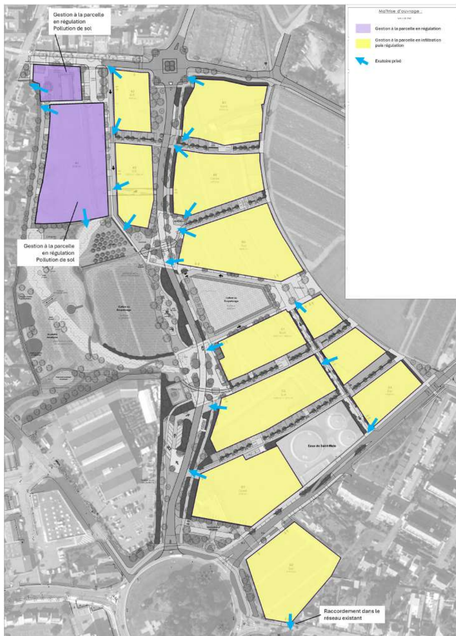
Figure 258 : Schéma bilan de la gestion pluviale des espaces privés du projet sur la base du plan de composition, Fond de plan : Artopia, annoté iao senn, 2025
